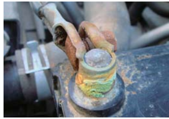
腐食したターミナル
