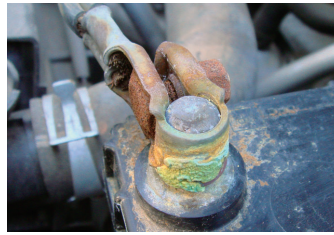
腐食したターミナル
